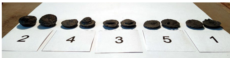
Рис. 1. Коксові корольки після випробувань шихти на спучування
