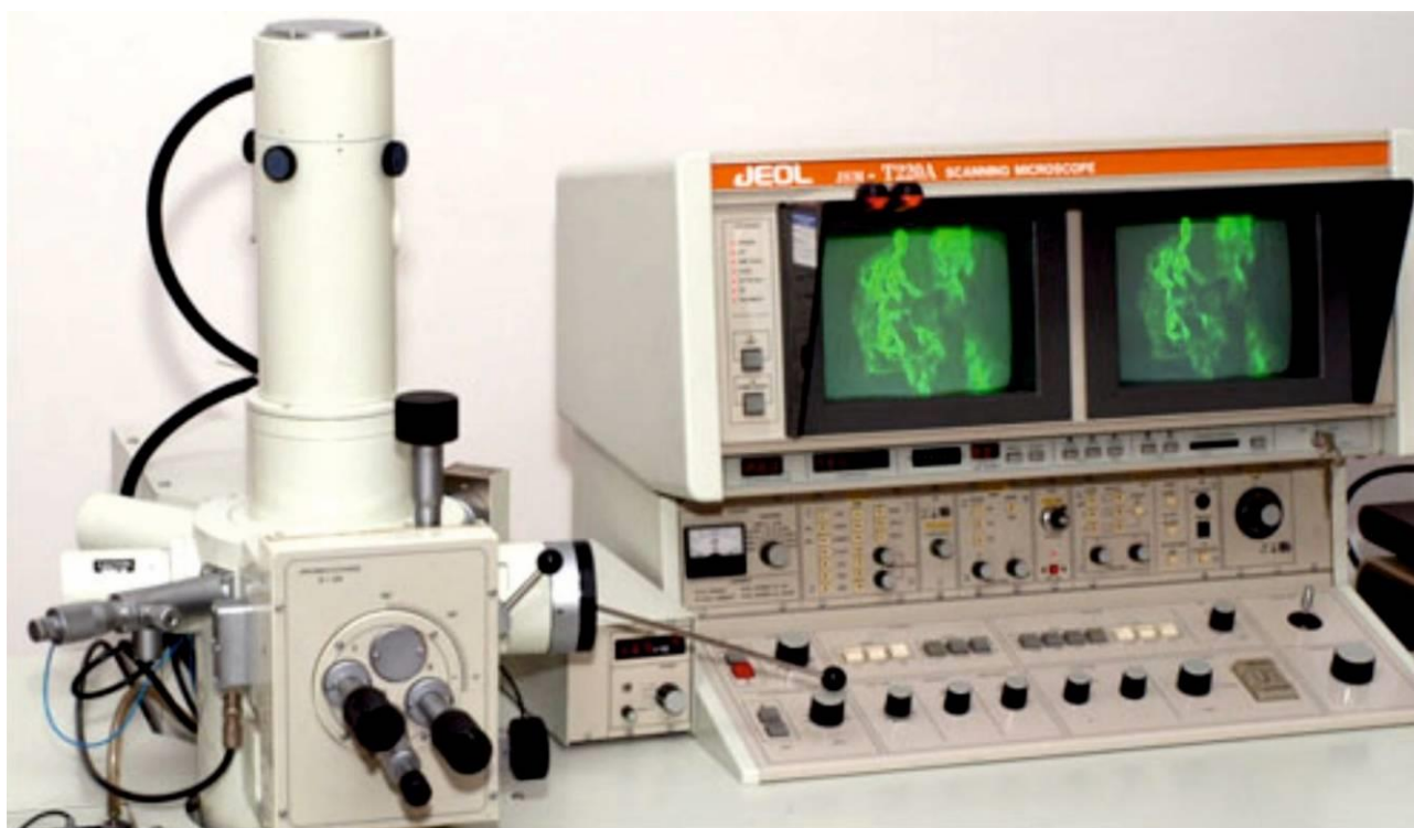
Рис. 2.2. Скануючий електронний мікроскоп JEOL JSM – T220A [Дацюк, 2010]. Технічні характеристики приладу: зображення: вторинні електрони (SEI), пружно-відбиті електрони (BEI), катодолюмінісценція (CLD); прискорююча напруга: 5-30 Кв; роздільна здатність: 5 nm (30 kV, робоча відстань 8 mm, SEI); збільшення: x15-x200,000; EDS система: QX200J (LINK), детектор Si(Li); аналіз: напівкількісний, якісний.
