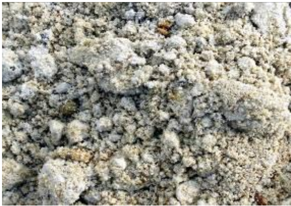
Рис. 3.12 Пісок різнозернистий кварц-каолінітовий ільменітоносний з відслонення району Канівських дислокацій
