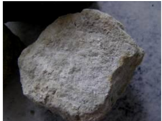
Рис. 3.13 Пісковик дрібно-середньозернистий ільменітоносний з відслонення району Канівських дислокацій
