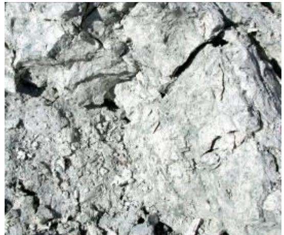
Рис. 3.28 Каолінова глина, яка утворилася за рахунок розмиву кори вивітрювання порід основного складу
