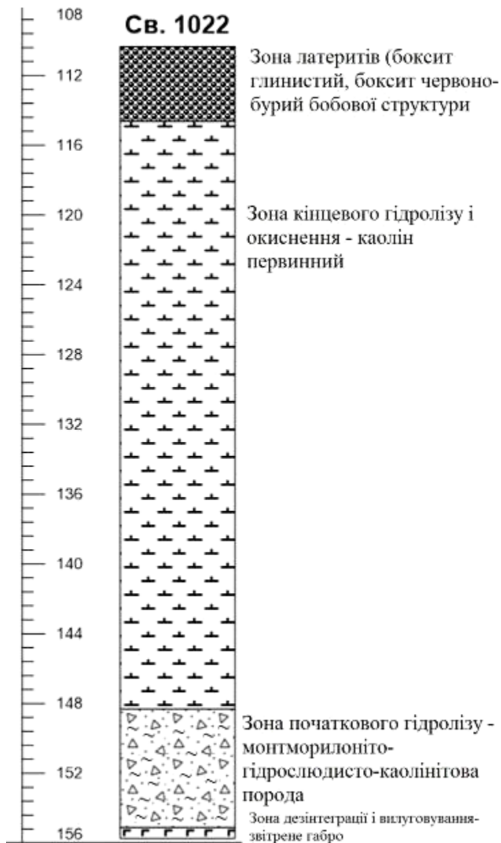
Рис. 2.2 Чотиричленний профіль латеритної кори вивітрювання за габро
