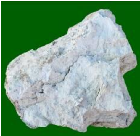
Рис. 3.27 Вторинний каолін, який утворився за рахунок розмиву кори вивітрювання порід основного складу
