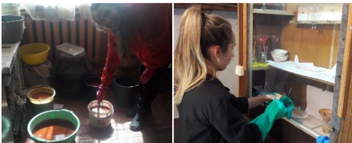
Рис. 3.4. Фізико-механічне розділення проби: а – знешламлення ; б – розділення «сірого шліху» у бромоформі.
