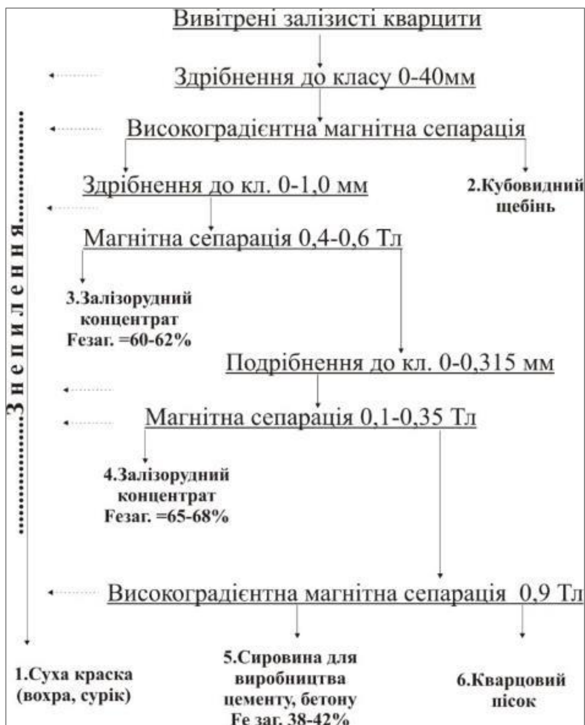
Рис. 5.3. Принципова технологічна схема комплексної переробки розкривних гематитових кварцитів центральної частини Криворізького басейну, за [101] з доповненнями автора.
