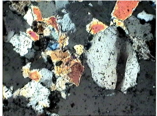
Рис. 3. Переривчасто-хвилясте згасання кварцу в різнозернистому пісковнику. Мехедівська св.1. Інт.5609-5620м 2,0м від верху. Відкрита пористість 7,1%, газопроникність 0,4мД. Довжина кадру 1,4мм. Ніколі+.
