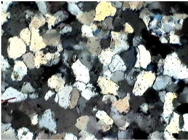
Рис.4. Пізньокатагенетичні структури кварцито-пісковиків а) гранобластова структура, Свиридівська св.3, інт.5284-5298м. довжина кадру 1.4 мм, ніколі+.б) рекристалізаційний бластез (зростання зерен кварцу) в кварцовому мономінеральному середньозернистому пісковику. Свиридівська св.3. 5008-5018м, довжина кадру 0,48мм, ніколі+.
