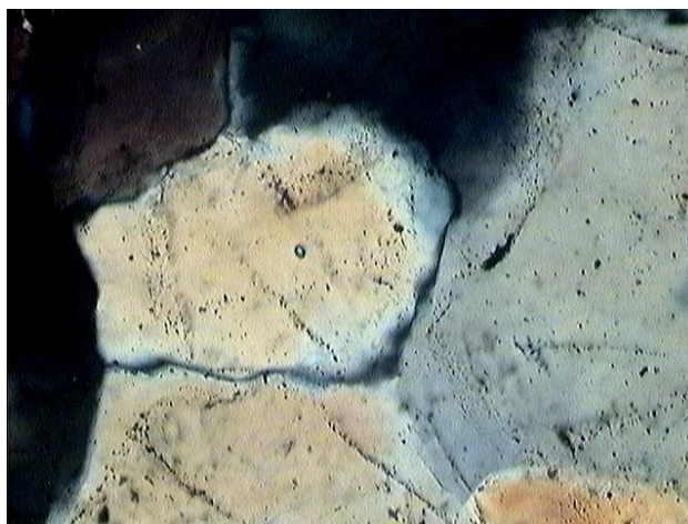
Рис. 5.8. Смужки Бьома в дрібнозернистому пісковику. Мехедівська св.1. Інт. 5709-5726м. Довжина кадру 0,48мм. Ніколі+.
