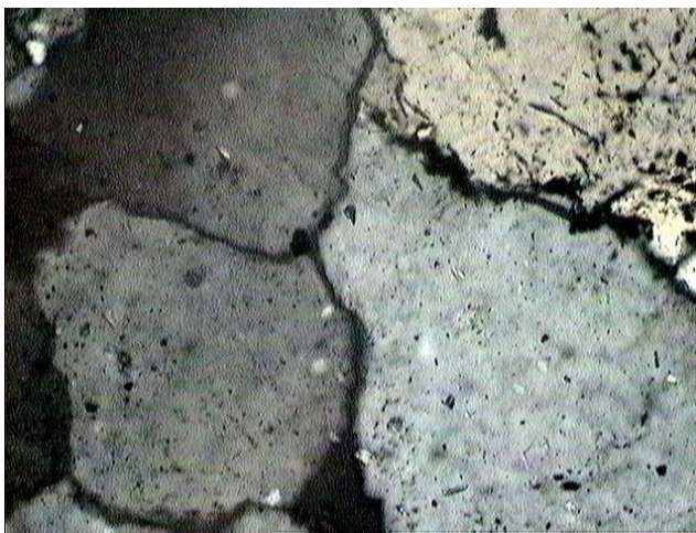
Рис. 5.2. Інкорпораційно-конформна структура породи та початок мікростилітизації Свиридівська сврд.3. Інт.5299-5309м. Нік.+. Довжина 0,48мм.
