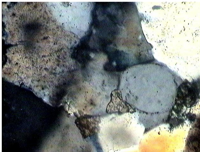
Рис. 4.1. Пісковик кварц-польовошпатовий, з карбонатним та кварцовим регенераційним цементом. Свиридівська сврд.4. Інтервал 5881-5890м. нік.+. Довжина 0,48мм
