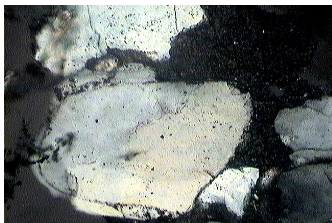
Рис. 5.4. Регенерація зерен кварцу та поровий аутигенний каолінітовий цемент в крупнозернистому пісковіку. Свирідівська сврд.3. Інтервал 5008-5018м. нік.+. Довжина 0,48мм
