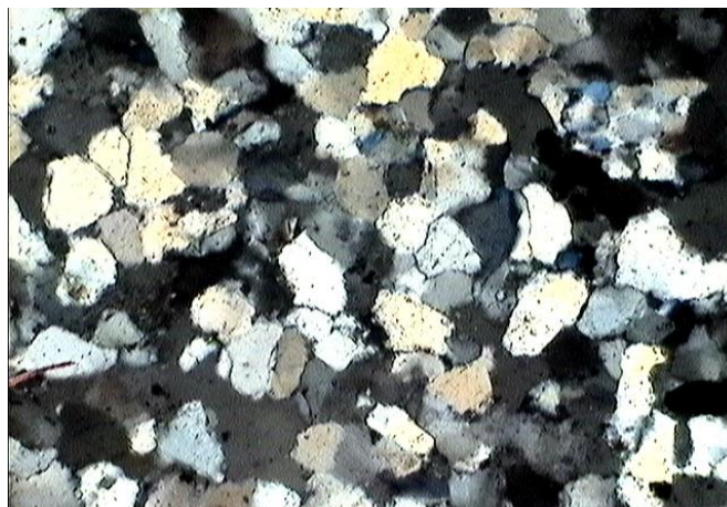
Рис. 4.4. Гранобластова структура кварцитопісковиків. Свиридівська св.3, Інт 5284-5298м. Нік.+ . Довжина 1,48мм.
