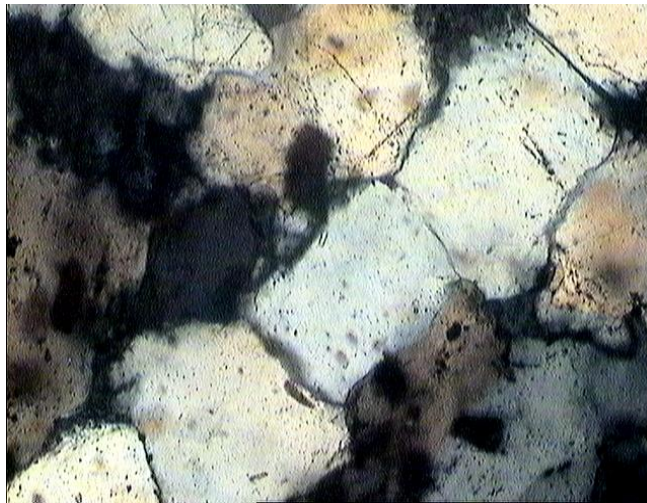
Рис. 4.8. Розчинення зерен кварцу та утворення лінійних вторинних контактів між зернами. Свирідівська св. 7 Інт. 5368-5372м. Довжина 0,48мм. Нік.+.
