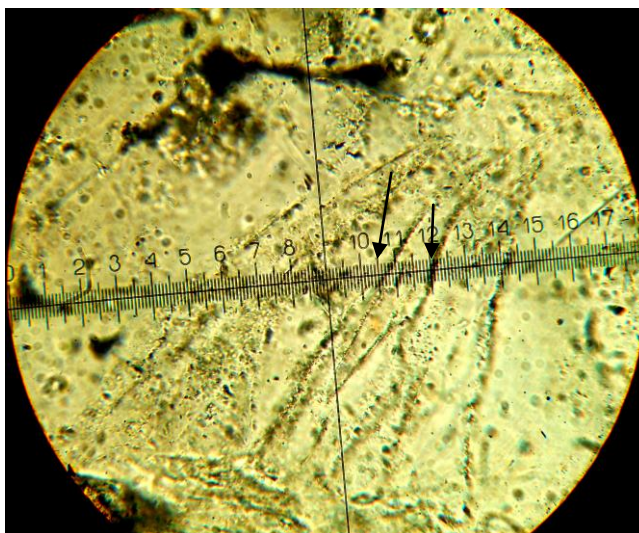
Рис. 5.7 Система субпаралельних смужок Бьома в зерні кварцу пісковика I_1Sl_2 , глибина відбору проби 450 м, ш. Курахівська, Красноармійський ГПР, зб. 1200 x
