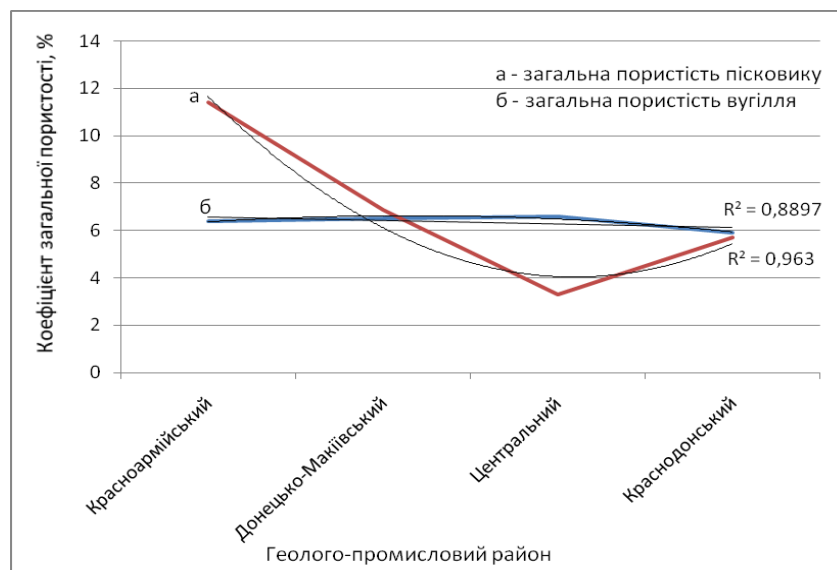
Рис. 4.3 Вплив тектоніки на перетворення загальної пористості вугілля марки Ж та прилеглих до нього пісковиків
