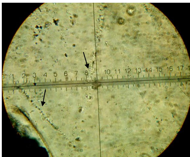
Рис. 5.10 Смужки Бьома у кварцовому зерні пісковика h_{10}Sh_{11} , глибина відбору проби 480 м, ш. Ровеньківська, Довжано-Ровенецький ГПР, зб. 1200 x
