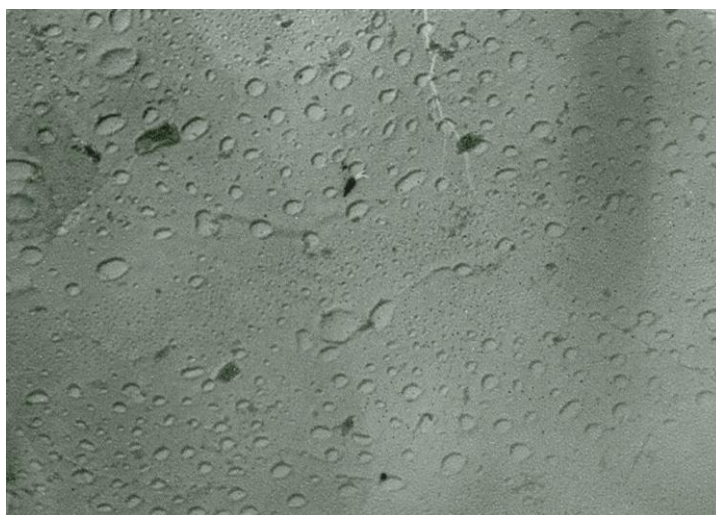
Рис. 2.2 Газові включення у кварцовому зерні карбонового пісковик у Донбасу при дослідженні методом ПЕМ (прилад ЕСВ - 100Л, зб. 2 000 x )
