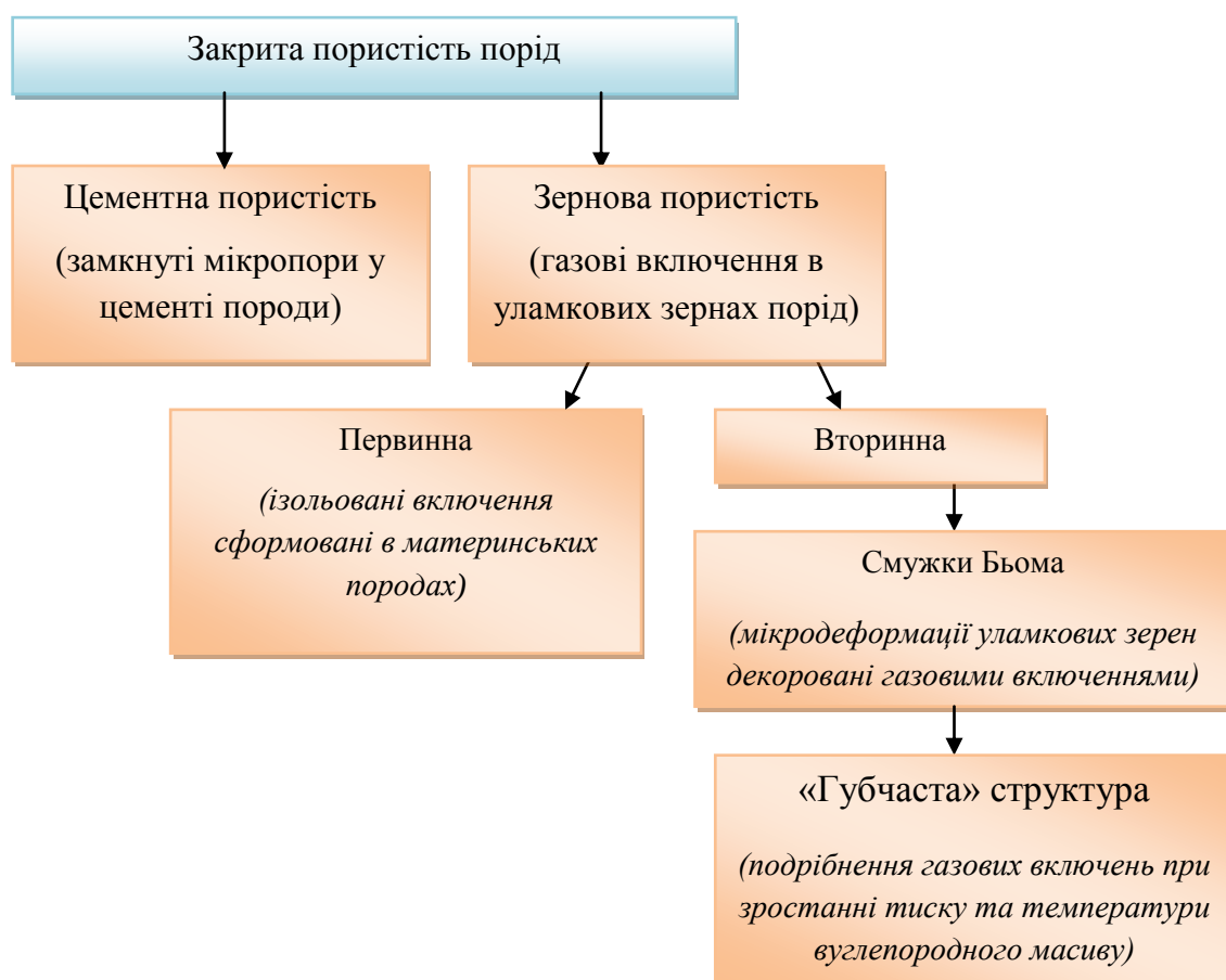
Рис. 5.2. Підтипи закритої пористості порід
