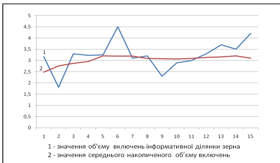
Рис. 5.4 Зміна середнього накопиченого об'єму включень в залежності від кількості досліджених інформативних ділянок шліфа
