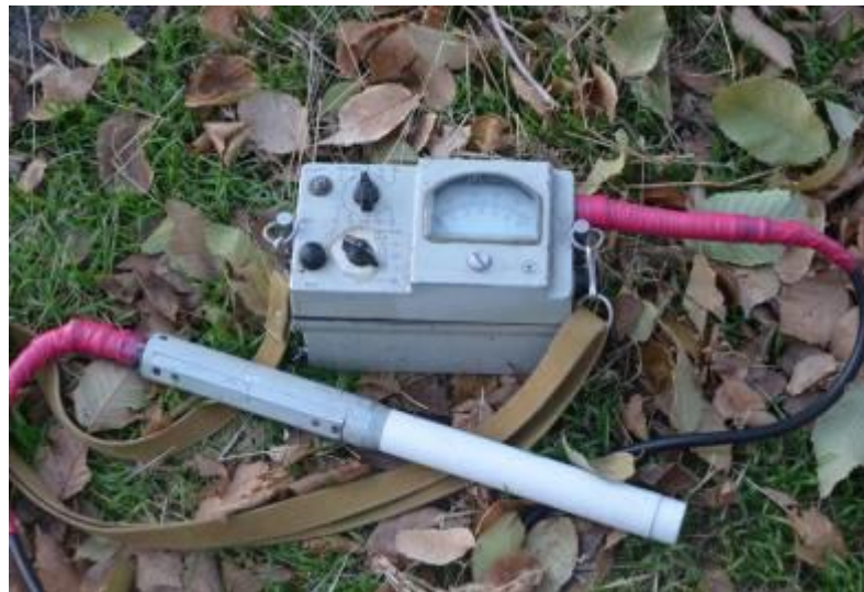
Рисунок 2.1 – Радіохвильовий індикатор пружно-деформованого стану порід (РХІПДС АХІ 2.026.001)
