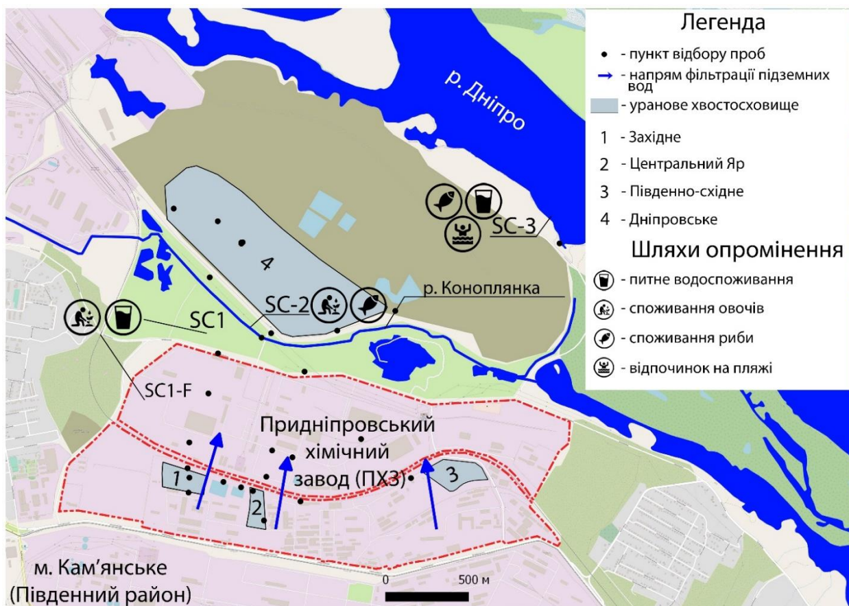
Рис. 25. Карта території ПХЗ з точками відбору проб підземних і поверхневих вод та піктограмами, що відображають сценарії водокористування.
