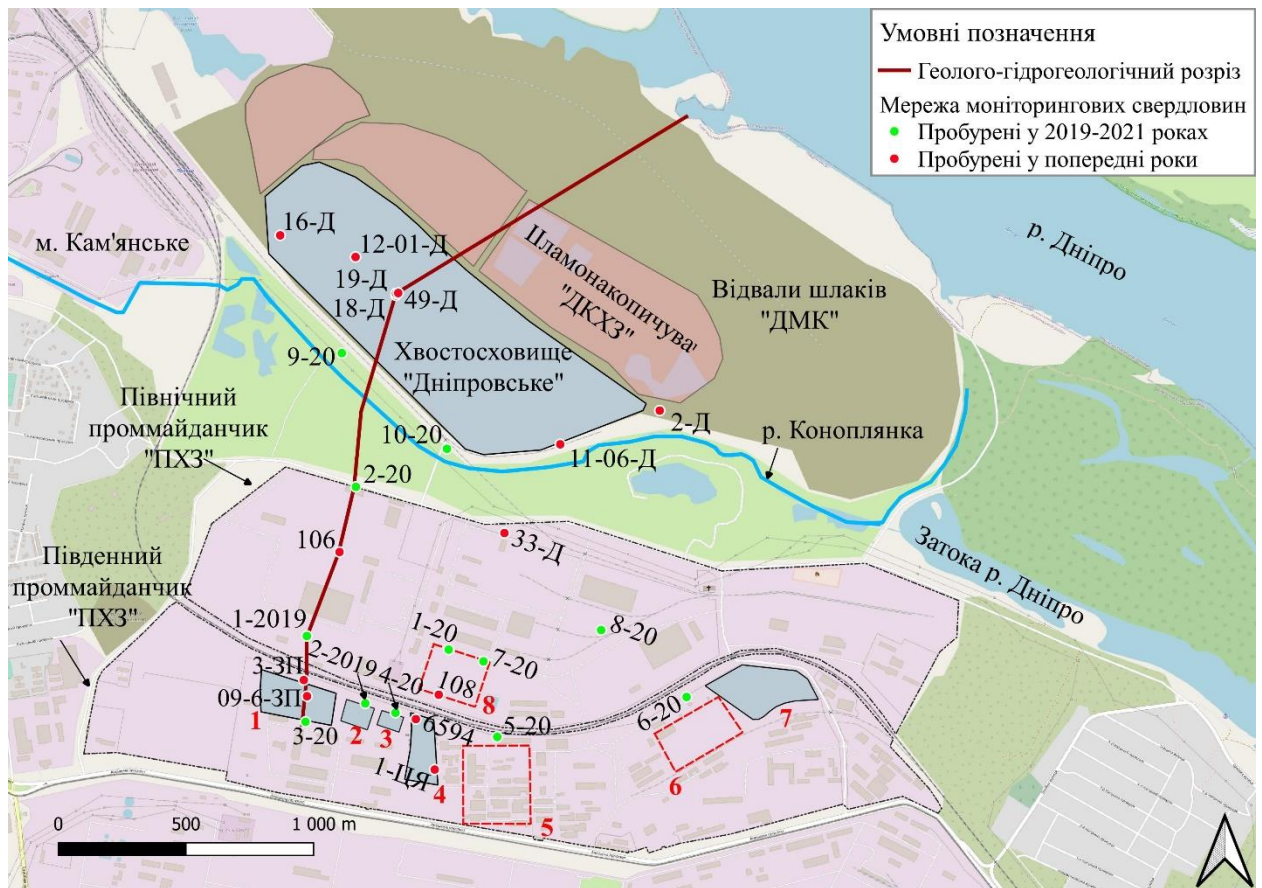
Рис. 4. Ситуаційна схема промислового майданчика ПХЗ і хвостосховища «Дніпровське»: 1 — хвостосховище «Західне»; 2 — відстійник № 220; 3 — відстійник № 230; 4 — хвостосховище «Центральний Яр»; 5 — комплекс радіохімічних цехів; 6 — майданчик розвантаження уранової руди; 7 — хвостосховище «Південно-східне»; 8 — «історичний» відстійник на Північному майданчику
