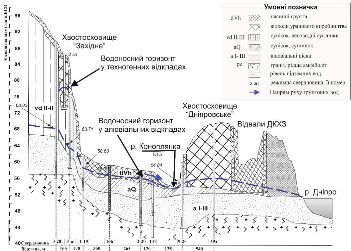
Рис. 11. Геологічний розріз промислового майданчика ПХЗ по лінії хвостосховище «Західне» - р. Коноплянка - хвостосховище «Дніпровське» (лінія розрізу показана на рис. 4).
